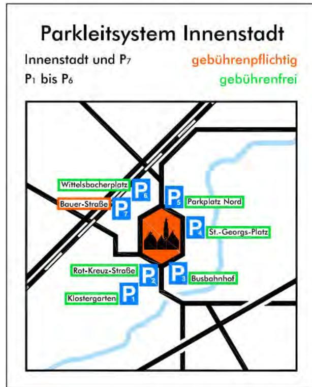
Abbildung 64: Beispiel Vorwegweiser für ein Parkleitsystem in Schrobenhausen
