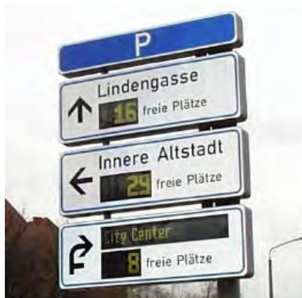
Abbildung 60: Beispiel dynamisches Parkleitsystem mit Restplatzanzeige
