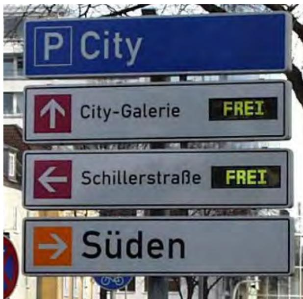
Abbildung 63: Beispiel dynamisches Parkleitsystem mit Frei/Belegt-Anzeige
