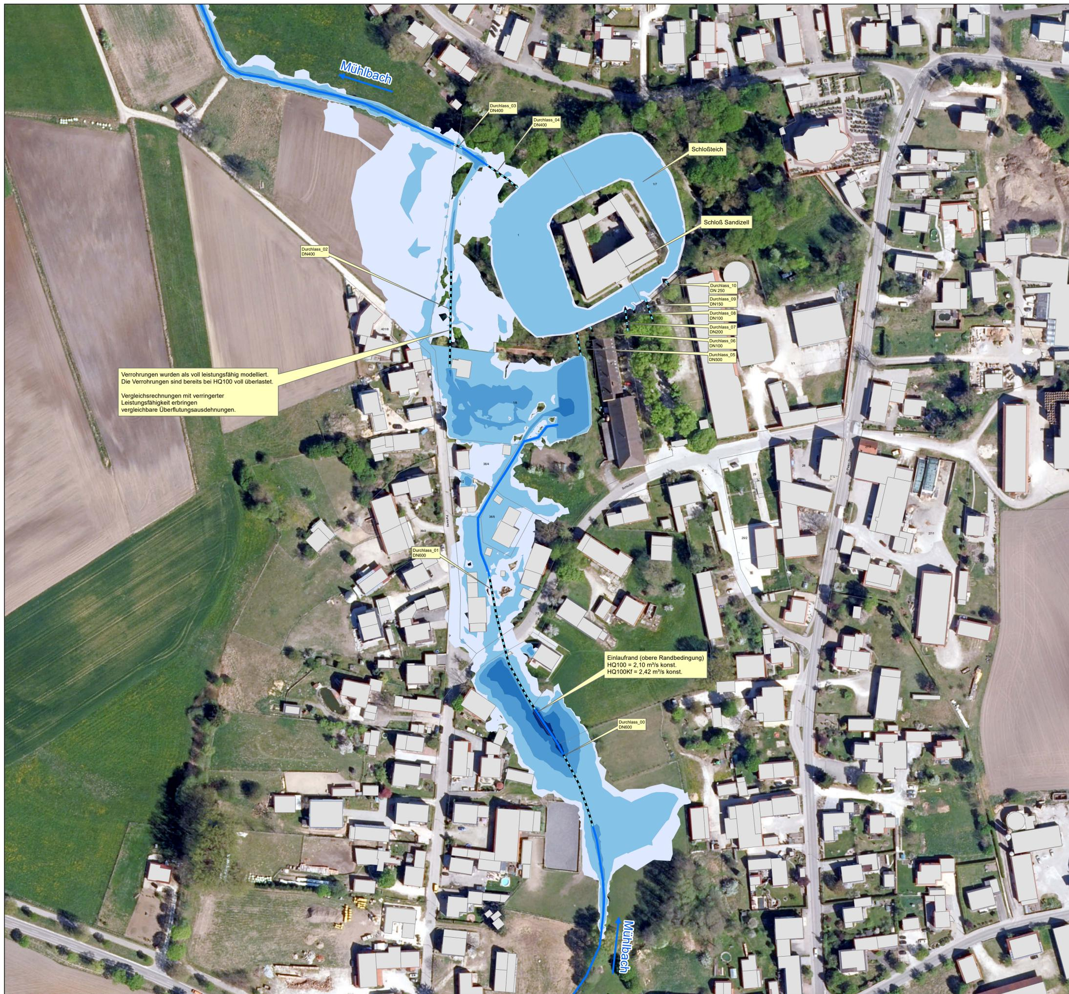
Verrührungen wurden als voll leistungsfähig modelliert. Die Verrührungen sind bereits bei HQ100 voll überlastet. Vergleichsrechnungen mit verringerter Leistungsfähigkeit erbringen vergleichbare Überflutungsausdehnungen.
